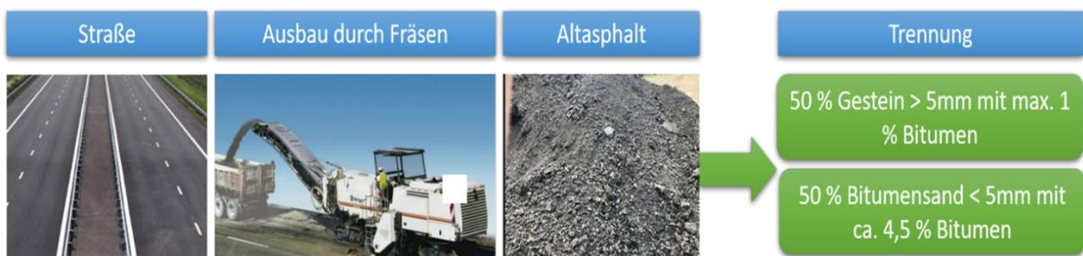
Im Rahmen des Forschungsvorhabens soll dann das Gestein und der Bitumensand untersucht werden, damit die Eigenschaften nach der Trennung analysiert werden können. Im Bereich des Bitumensandes ist dann das größere Potenzial, um die Eigenschaften optimieren zu
